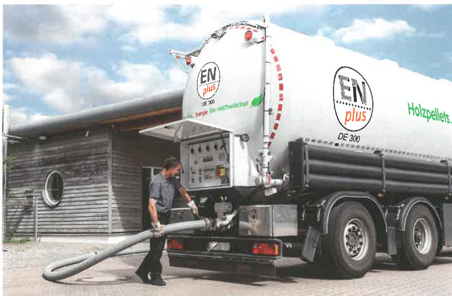
Pellets werden lose per Lkw angeliefert und ins Lager des Kunden eingeblasen.
