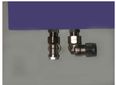
6. Ventile montieren und dicht verschrauben.
