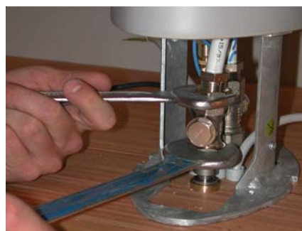
8. Anschlußnippel mit Absperrventil verschrauben.
